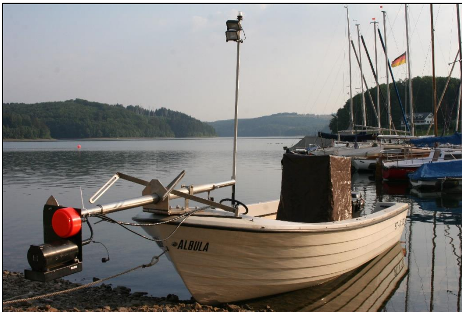
Abbildung 5: Split-Beam-Echolot montiert am Arbeitsboot (© LFV Hydroakustik GmbH)
